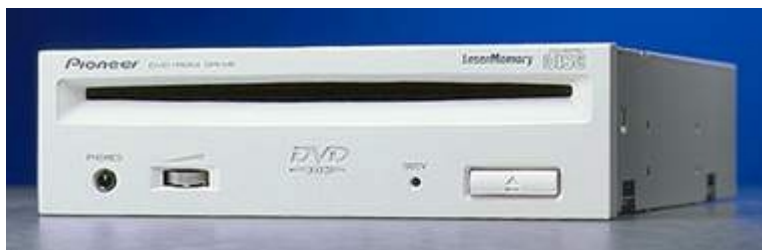
Ein DVD-Laufwerk von Pioneer mit Slot-In-Technik
