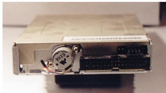
Das gleiche Laufwerk von der hinteren Seite (unten rechts: 40-poliger Stecker für das Datenkabel, links: Stromanschluss)
